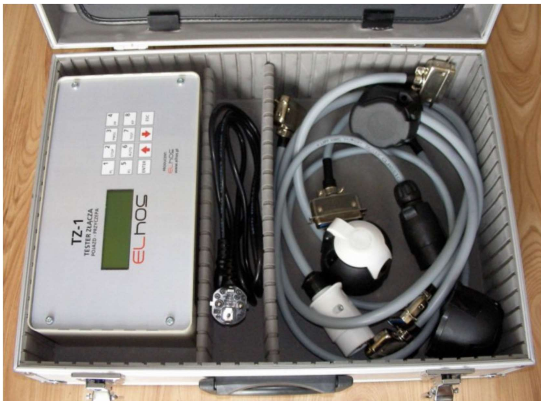
Rys 2. Tester Złącza Pojazd-Przyczepa w walizce transportowej, z kompletem złączy dla instalacji 12V
