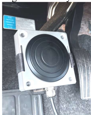
Rys. 5 Mocowanie miernika nacisku na pedale hamulca
