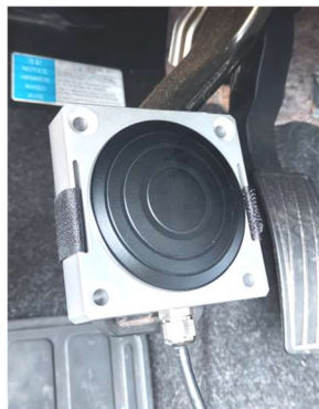
Rys. 5 Mocowanie miernika nacisku na pedale hamulca
