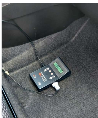
Rys. 4 Umieszczenie opóźniomierz w pojeździe
