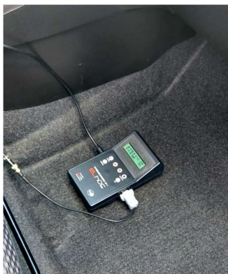
Rys. 4 Umieszczenie opóźniomierza w pojeździe
